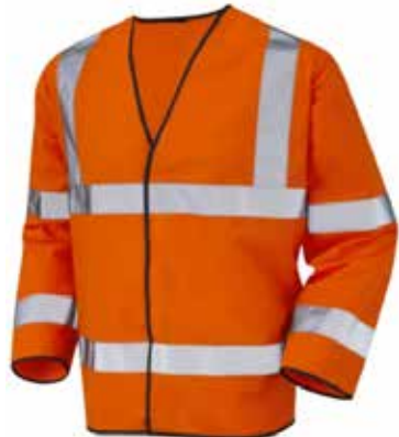
AFBEELDING 7. NIEUW: VEILIGHEIDSIJAS (NEN-EN-ISO 20471, VEILIGHEIDSKLASSE 3). LET OP DE VERTICALE RETRO-REFLECTERENDE BANDEN.
